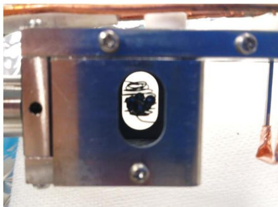
Figure4.7 タングステン線バケットに入ったSb。金属マスクにより蒸着方向を制限している[0-2]。
