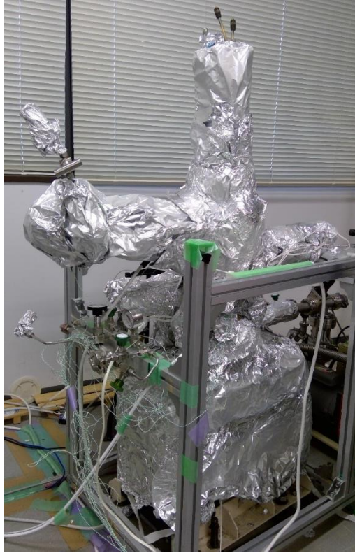
図 3.8 ベーキング中の真空容器本体写真。巻かれたアルミホイルは保温と容器全体の温度の均一性を保つ役割がある。
