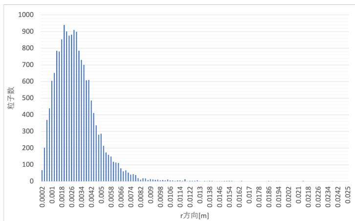
図 4.12 横方向の実空間(r 方向)におけるヒストグラム.縦軸:粒子数,横軸:r 方向[m]
