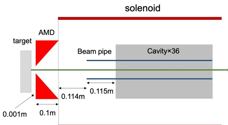
図 4.13 ターゲットから空洞入口までの概要図.
