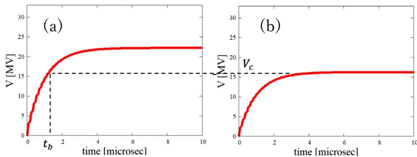
図 4.8 縦軸:空洞電圧[MV]、横軸:時間[ $\mu s$ ].(a)  $I_{RF}$  入力の結果 (b)  $I'_{RF}$  入力の結果
