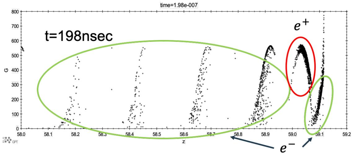
図 4.14 GPT による粒子トラッキングの結果.キャプチャーライナック入口付近の  $t=5\text{nsec}$  の分布から  $t=50\text{nsec}$ 、 $t=100\text{nsec}$ 、 $t=198\text{nsec}$  の順で表示している.赤丸で囲んだ場所に陽電子が存在し、緑丸で囲んだ場所に電子が多く存在する.
