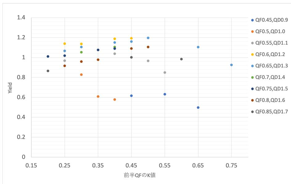
図 5.12 K 値と陽電子捕獲率の関係.縦軸:陽電子捕獲率、横軸:前半 QF の K 値
