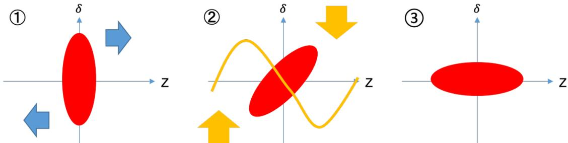
図 3.13 ECS を通過する時の位相空間分布の動きを表した図。縦軸はエネルギー、横軸は位置  $z$  を表す。まずシケインを通ると、momentum compaction により①のようにバンチが時計回りに傾く。次に②のように加速空洞内で RF 電場のゼロクロスにバンチを置くことで、③のようにエネルギー広がり小さくなる
