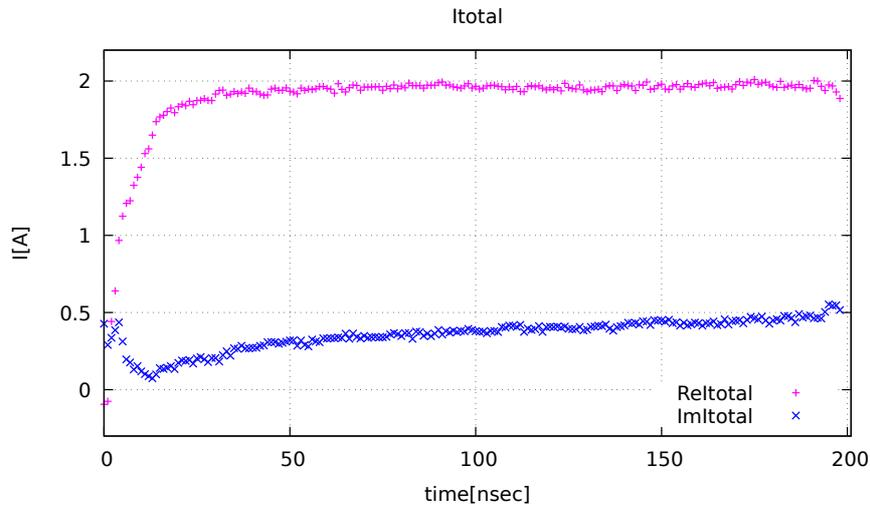
図 4.18 粒子全体のビーム電流の実数成分、虚数成分の時間変化を示し、縦軸は電流  $I[\text{A}]$ 、横軸は時間  $[\text{nsec}]$  を表している。実数成分は約  $2.0[\text{A}]$ 、虚数成分は  $0.5[\text{A}]$  ほどに落ち着いている。
