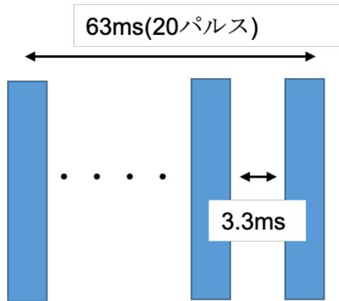
図 3.3 陽電子源のパルスの時間構造.33 バンチ×2 を 1 パルスとして、このパルスを 300Hz で 20 回繰り返す.
