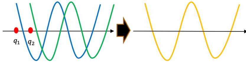
図 4.2 粒子が作り出すビームローディングの重ね合わせの概念図。
