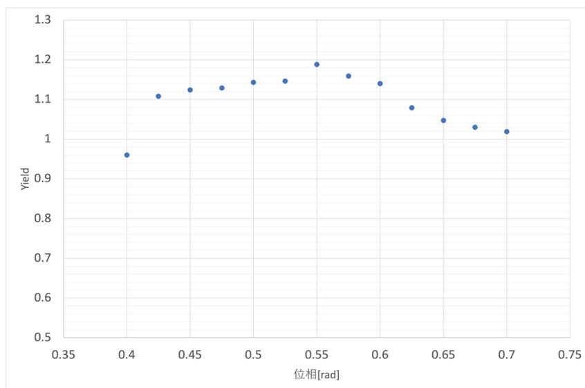
図 5.10  $\phi_0$ と陽電子捕獲率の関係.縦軸: 陽電子捕獲率、横軸:  $\phi_0$  [rad]
