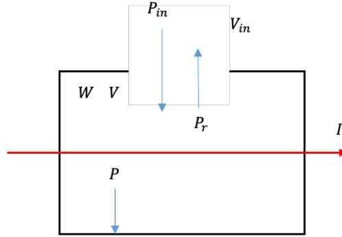
図 4.1 定在波加速空洞の単セルモデル. $W$ は空洞に蓄積されるエネルギー、 $V$ は空洞の電圧、 $P_{in}$ は外部からの入力パワー、 $P_r$ は反射パワー、 $V_{in}$ は導波管の電圧、 $I$ はビーム電流を表す。
