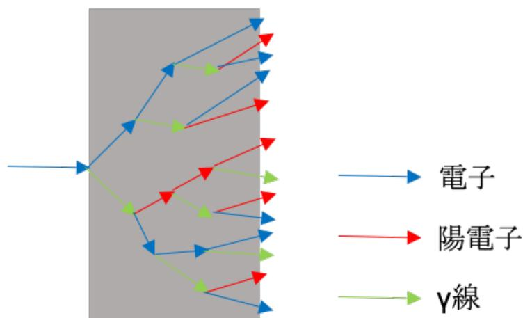
図 2.2 電磁シャワーの模式図.標的内で物質の電磁場により軌道を曲げられた電子が制動放射により、 $\gamma$ 線を発生させる.発生した $\gamma$ 線は対生成反応により電子と陽電子に分かれる.これらの反応が連鎖的に起こることによって、電子・陽電子が大量に生成される.
