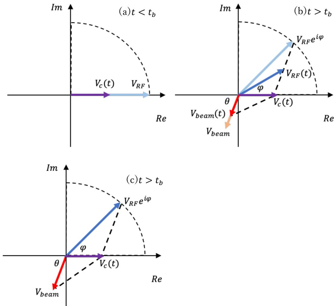
図 4.4 位相変調を施した場合の空洞電圧の過渡的な変化を複素平面上に表したものの。 $V_{RF}$ はビーム入力前のRFの漸近値、 $V_{beam}$ はビームの電圧の漸近値、位相変調をかけた時のRFの漸近値は $V_{RF}e^{i\varphi}$ 、 $V_c(t)$ は空洞電圧 $V_{RF}(t)$ 、 $V_{beam}(t)$ は時間 $t$ におけるRFとビーム電圧である。(a)にビーム入力開始前、(b)(c)にビーム入力開始後の電圧を表す。
