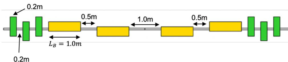
図 3.8 シケインの概要図.黄色の長方形はベンディングマグネット、緑の長方形は Q マグネットを表す.それぞれの長さを図に示しておりベンディングマグネットの長さを  $L_B$  としている。
