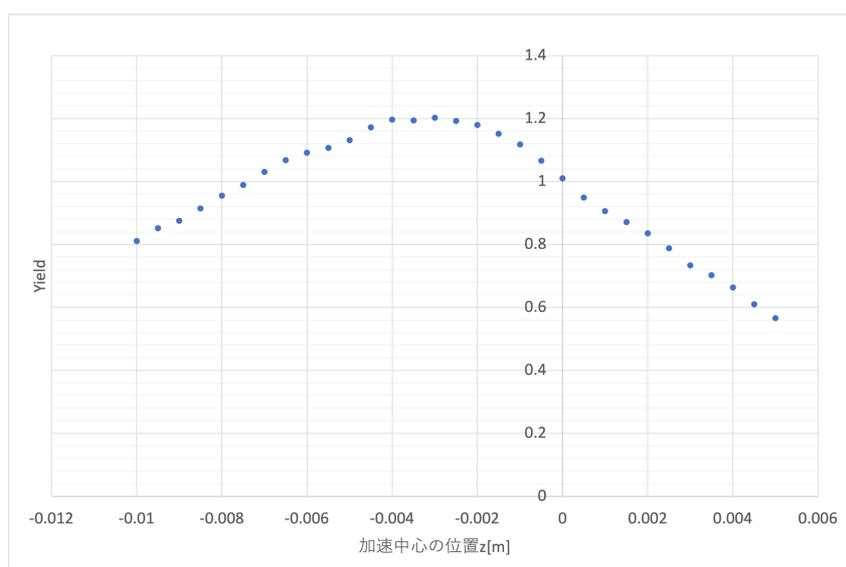
図 5.18 アクセプタンス中心の合わせ込みを行った際のブースター位相と陽電子捕獲率の関係.横軸: 加速中心位置  $z$  [m]、縦軸: 陽電子捕獲率
