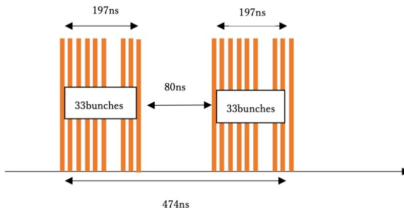
図 3.4 電子ビームの時間構造[3].33×2 を 1 パルスとして、バンチ間隔を 6.15ns、トレインの間隔を 80ns とする.
