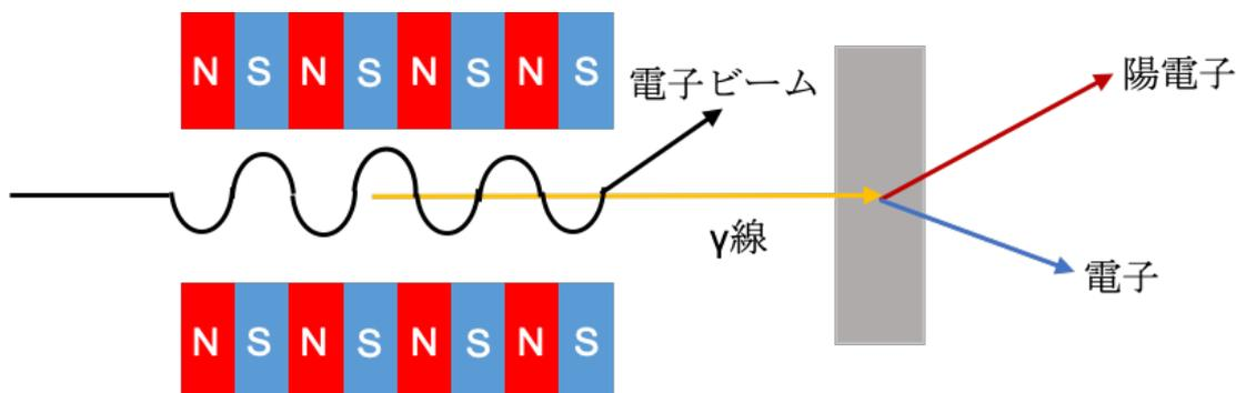
図 2.3 アンジュレータ方式の模式図.周期的な磁場に電子を入射して蛇行させることにより、放射光を発生させる.
