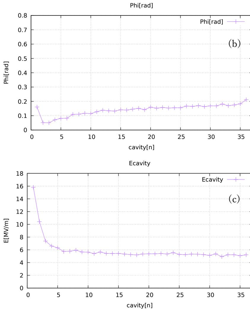
図 4.19 (a):ビーム位相、(b):位相変調量 $\phi$ 、(c)空洞電場の加速管ごとの値
