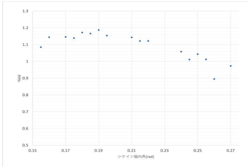
図 5.11 シケイン偏向角 $\theta$ と陽電子捕獲率の関係.縦軸: 陽電子捕獲率、横軸:  $\theta$  [rad]
