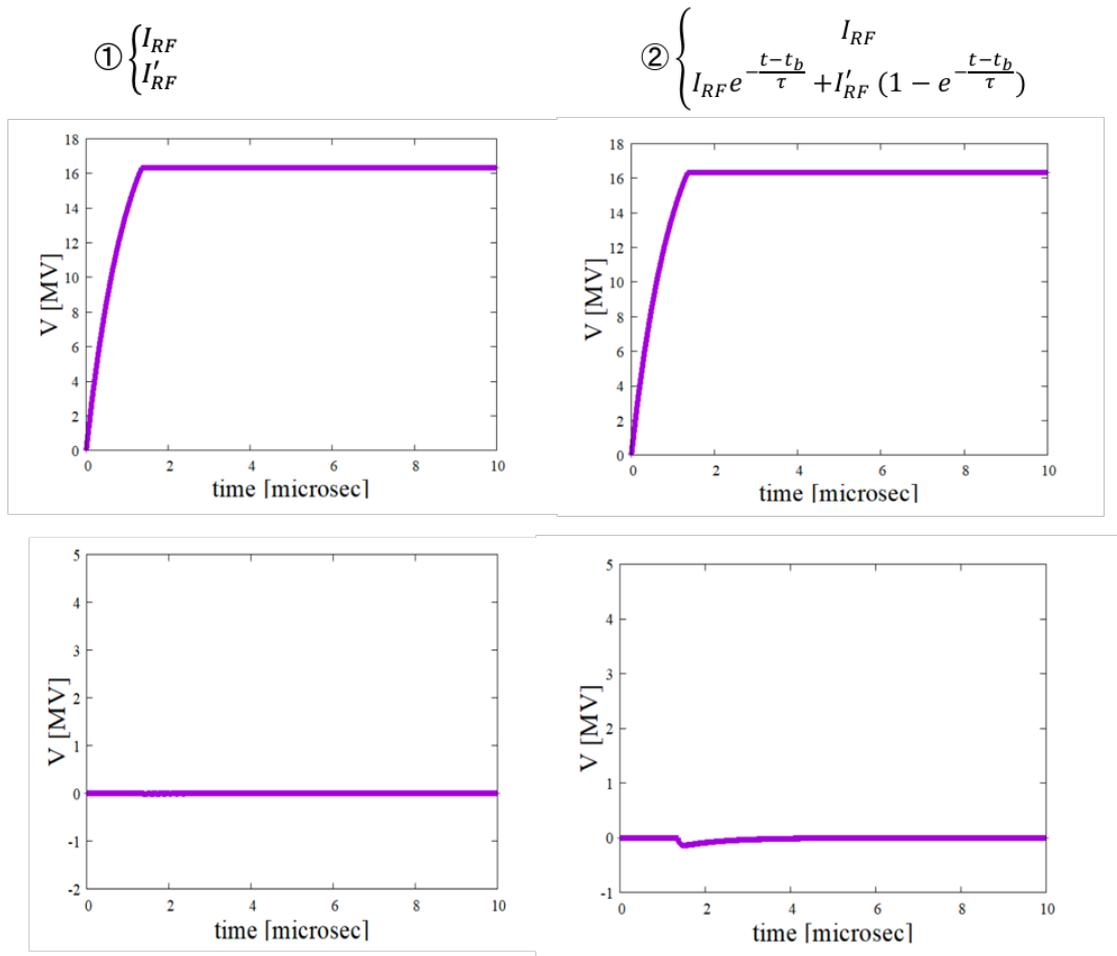
図 4.9 位相変調を加えた時の空洞電圧の過渡的な変化.①は階段関数で RF 電流が変化する場合、②がクライストロンの影響を含んだ場合の結果.上図:実数成分、下図;虚数成分を表す.縦軸:空洞電圧[MV]、横軸:時間[ $\mu$ s].
