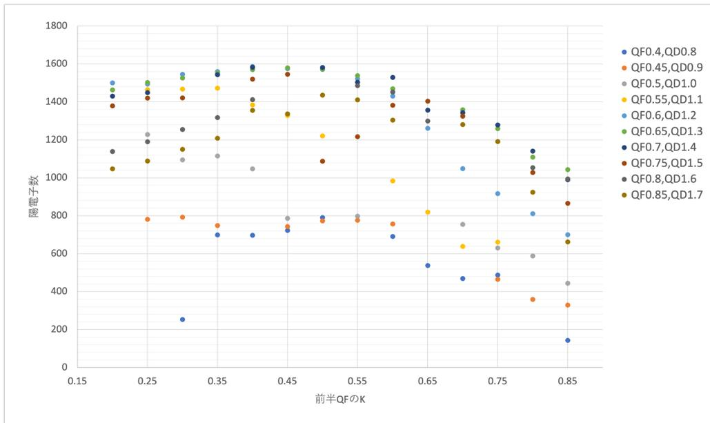
図 5.7 四重極磁石の K 値と陽電子数の関係.縦軸:ブースター4Q1L 出口の陽電子数、横軸:前半 QF の K 値.後半の K 値は色によって分けており、その判例を図右上に示した
