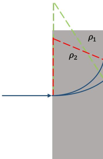
図 3.10 エネルギーの違う粒子が偏向電磁石を通過する際の軌道の違いを表した図。高いエネルギーの曲率半径を  $\rho_1$ 、低いエネルギーの曲率半径を  $\rho_2$  とした。曲率半径が大きいと軌道が短くその粒子は前方に移動する。
