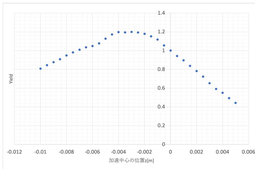
図 5.15 加速中心の位置  $z$ [m]と陽電子捕獲率の関係.縦軸:陽電子捕獲率、横軸:加速中心の位置  $z$ [m]
