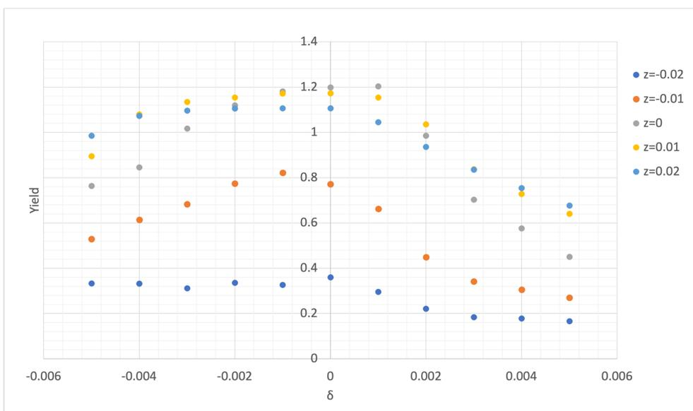
図 5.17 ブースターRF 位相=-0.003[m]の時に、アクセプタンス中心を動かした時の陽電子捕獲率.横軸:  $\delta_{off}$ 、縦軸: 陽電子捕獲率として、色分けにより  $z_{off}$  を示し、その凡例を図右上に表記する.
