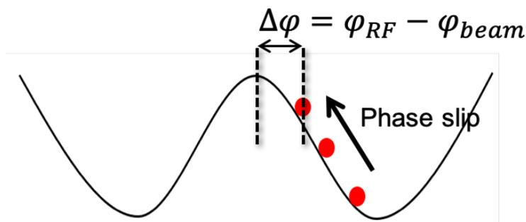
図 3.7 粒子の Phase Slip を表した図.粒子は最終的に RF 位相 $\varphi_{RF}$ に対して off-crest の状態に留まり、位相差 $\Delta\varphi$ を持つ。
