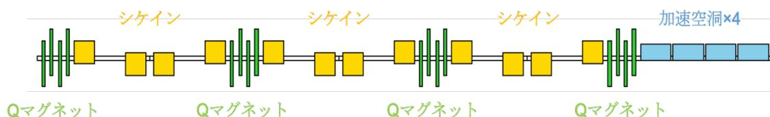
図 3.12 ECS の概要図.3 つのシケイン、4 つの QM 対、4 本の加速空洞からなる。
