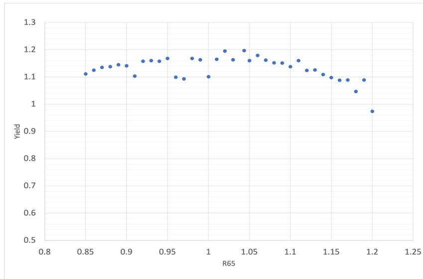
図 5.14 R65 と陽電子捕獲率の関係.縦軸: 陽電子捕獲率、横軸:R65.R56=0.96 としている
