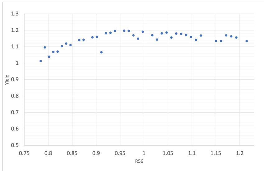
図 5.13  $R_{56}$  と陽電子捕獲率の関係.縦軸: 陽電子捕獲率、横軸: $R_{56}$
