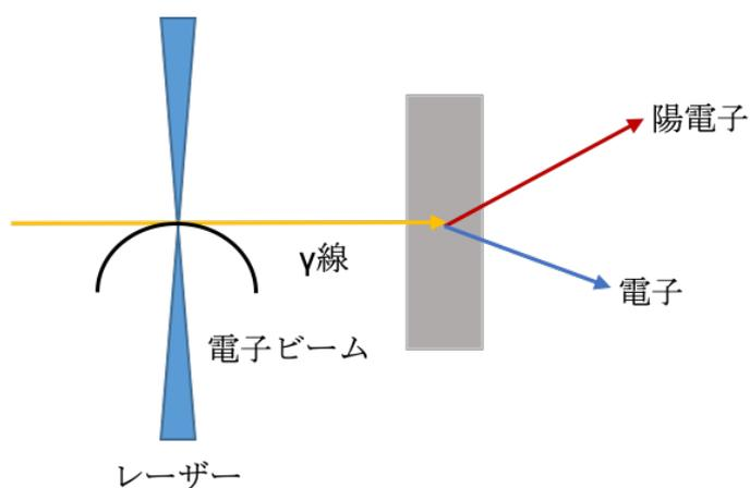
図 2.4 コンプトン方式の模式図.電子ビームとレーザー光のコンプトン散乱により $\gamma$ 線を発生させる.
