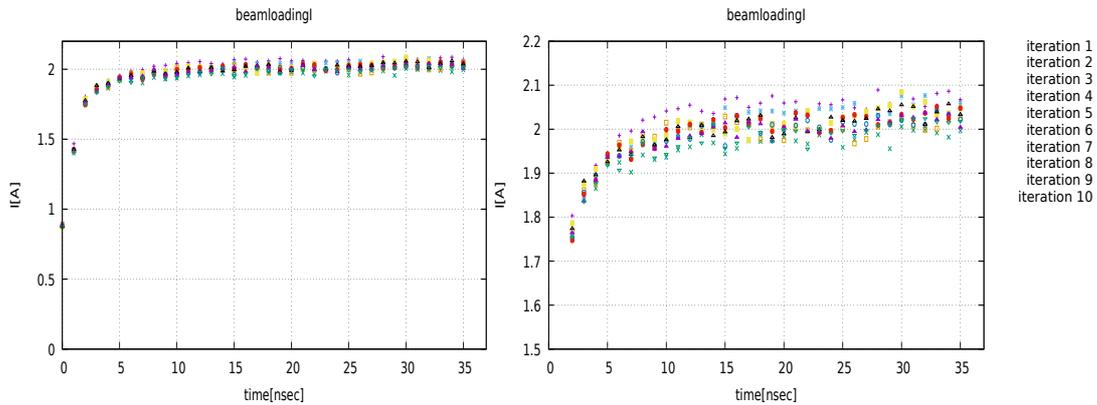
図 4.20 加速管ごとのビームローディング電流。左図に縦軸の範囲[0:2.2]、右図に縦軸の範囲[1.5:2.2]の結果を載せる。イタレーションごとの結果を色ごとに示し、その凡例を図右側に表す。
