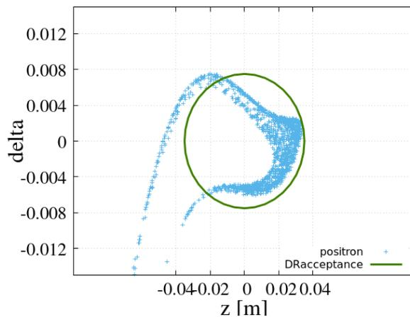
図 5.16 ECS 出口の位相空間分布.緑の円は縦方向の DR アクセプタンスを表し、その円の中心位置はエネルギー5[GeV]、 $z$  はバンチの平均位置[m]としている。
