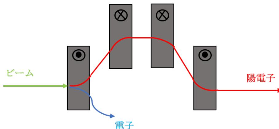
図 3.9 BM を通過する時の電子・陽電子の軌道を表した模式図.青矢印は電子の軌道、赤矢印は陽電子の軌道をしめす.一つ目のベンディングマグネット通過後に電子は陽電子と逆側に曲げられ、除去される。
