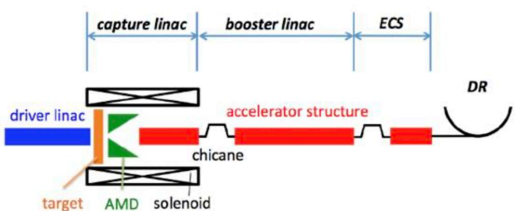
図 3.1 ILC 電子ドライブ方式の陽電子源の概要図[2].標的に電子ビームが照射されることにより陽電子が発生し、キャプチャーライナックにて加速可能な領域まで捕捉される。シケインにて z 方向の広がりを抑えられた後、ブースターで 5GeV まで加速され、最終的に ECS にてエネルギー幅を DR アクセプタンス内に収められる。
