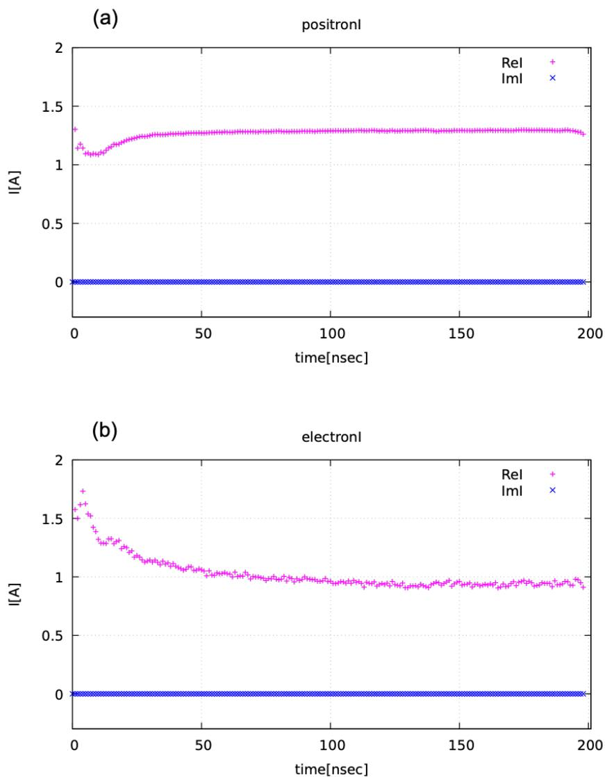
図 4.17 ビーム電流の実数成分、虚数成分の時間変化を示し、縦軸は電流  $I$ [A]、横軸は時間[nsec]を表している。(a)の図は陽電子、(b)の図は電子の結果である。粒子の重心位相を基準に計算しているため、虚数成分は電子・陽電子ともに 0 になっている。
