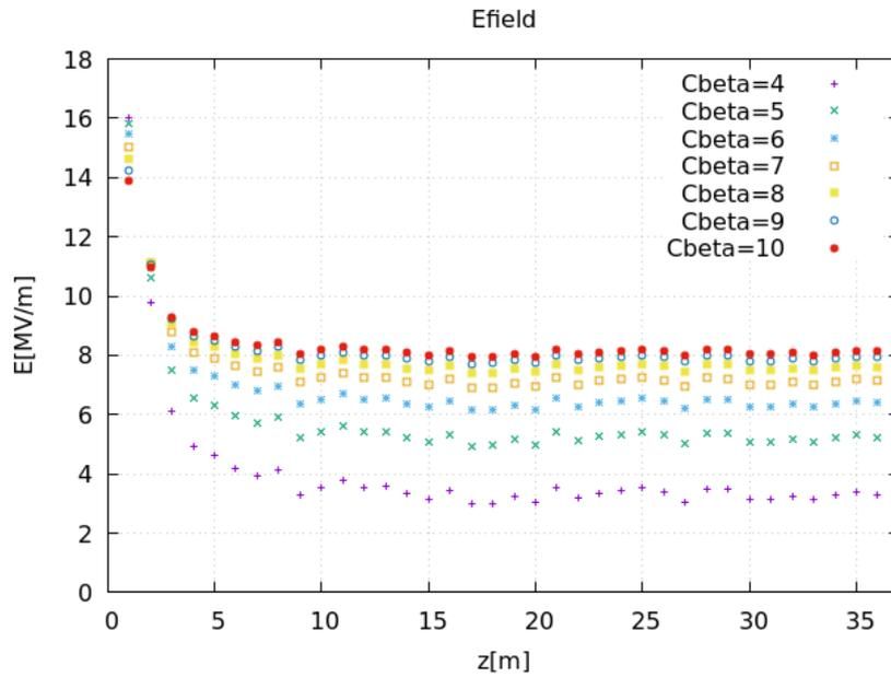
図 5.1  $\beta$  ごとの空洞電場. 縦軸: 空洞電場 [MV/m]、横軸:  $z$  [m].  $\beta$  ごとのデータをプロットしておりその凡例を図右上に載せた.
