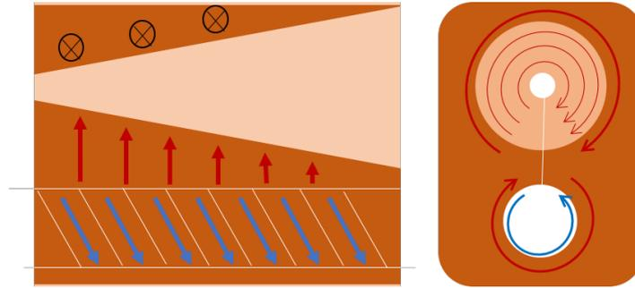
図 3.5 二導体 FC の断面図.左図が横断面、右図が下流方向から上流方向を見た様子.第一導体にパルス電流を流すことで、内部に磁場が発生し、それにより第二導体内部に電流が誘起される.円錐形をとっているため、上流部と下流部で磁束密度が変化する.
