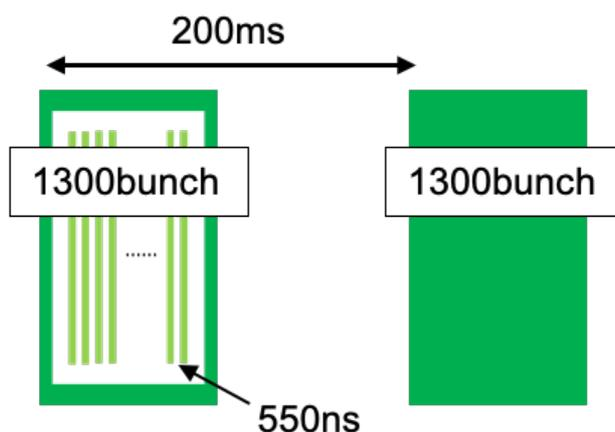
図 3.2 主加速器のパルスの時間構造. 1 パルス 1300 バンチのパルスを 5Hz で運転する. またバンチの間隔は 550nsec である。
