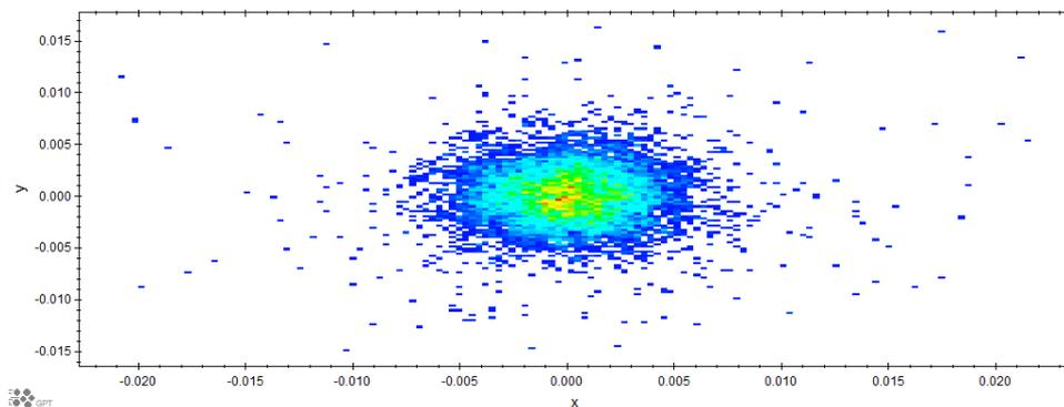
図 4.11 生成直後のビームの横方向の密度分布.縦軸:y[m],横軸:x[m]
