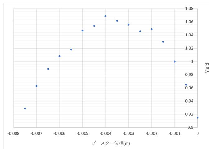
図 5.9 陽電子捕獲率と加速中心の関係. 縦軸:陽電子捕獲率、横軸:加速中心  $z[\text{m}]$
