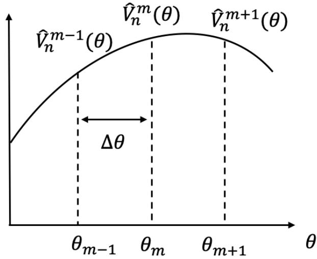
図 4.6 有限差分近似の概念図.独立変数 $\theta$ を離散化して格子点を作る.隣り合う格子点の幅を $\Delta\theta$ とし、 $m$ 番目の格子点の時の電圧を $\hat{V}_n^m(\theta)$ とする.
