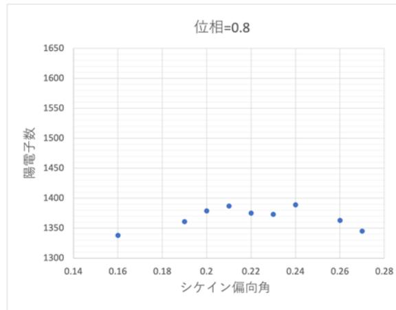
図 5.2 初期位相 $\phi_0$ [rad]ごとのシケイン偏向角 $\theta$ [rad]とブースター4Q1L 出口の陽電子数の関係.縦軸: ブースター4Q1L 出口の陽電子数、横軸:  $\theta$ [rad].RF の $\phi_0$ [rad]はそれぞれのグラフの上部に記載している
