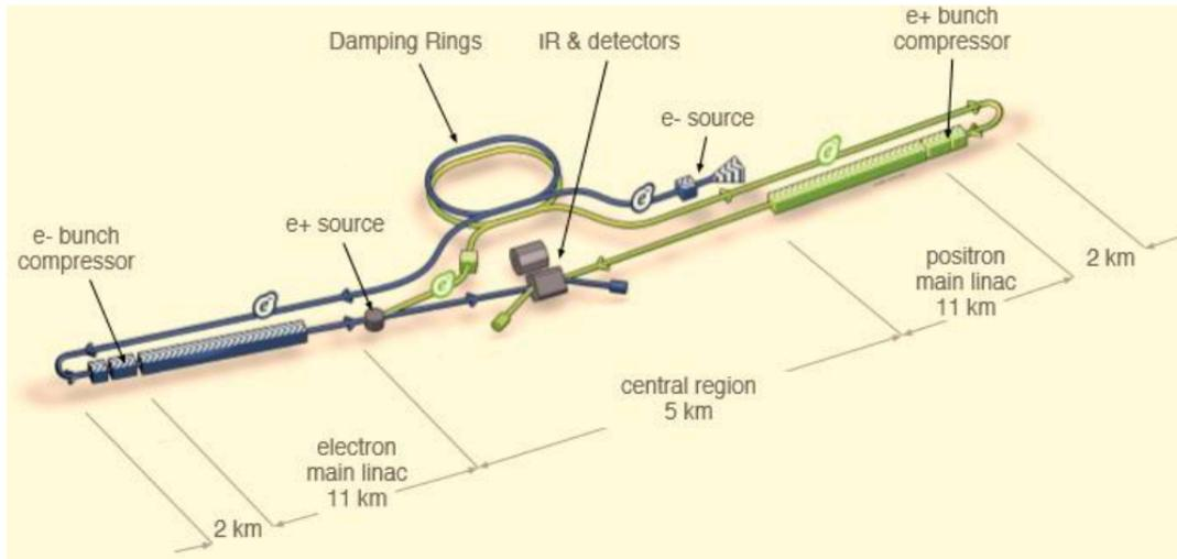
図 2.1 ILC の模式図[1].電子および陽電子は線形の超伝導加速器により加速され中央で衝突する.
