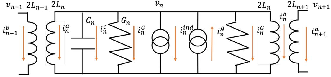
図 4.7 カプラーセルの等価回路モデル
