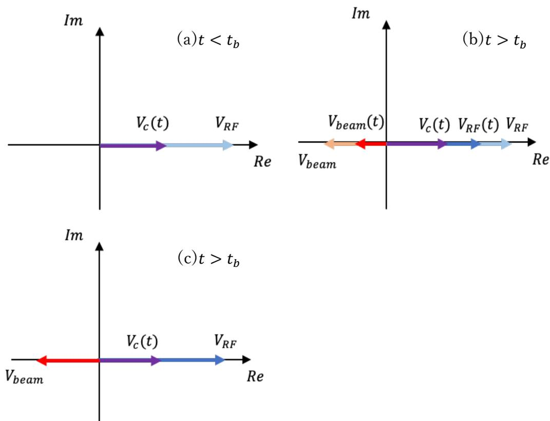
図 4.3 空洞電圧の過渡的な変化を複素平面上に表したもの。 $V_{RF}, V_{beam}$  は RF とビームの電圧の漸近値、 $V_c(t)$  は空洞電圧、 $V_{RF}(t), V_{beam}(t)$  は時間  $t$  における RF とビーム電圧である。(a) にビーム入力開始前、(b)(c) にビーム入力開始後の電圧を表す。
