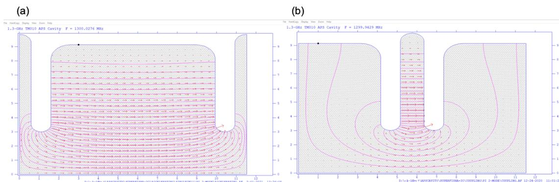
図 3.6 APS 空洞の(a)加速セル、(b)結合セルを示した図.ピンク色の矢印は電場の向きを表している
