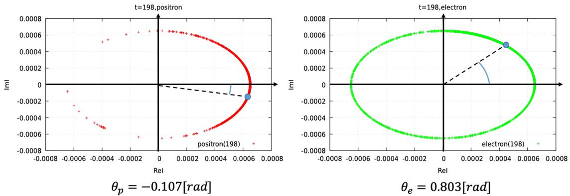
図 4.15  $t=198\text{nsec}$  の時の重心位相を表す図.縦軸に粒子の虚数成分、横軸に実数成分を取り各粒子の実数、虚数成分を複素平面状に表したもの.左:陽電子,右:電子.
