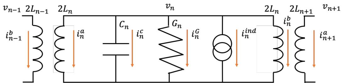
図 4.5 レギュラーセルの等価回路モデル。
